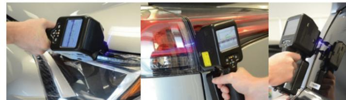
**Routine- und Messmodi** – Entwickelte Inspektionsroutinen können direkt durch die LGWorks-Software mit dem Sensor ausgeführt werden. Detaillierte Grafiken und Bildschirmmitteilungen führen den Prüfer von einer Messung zur nächsten. Komplexe Berechnungen aus den Messdaten können im Rahmen der Routine verarbeitet und in die Datendatei eingebunden werden.
