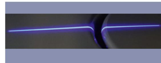
Der Firma Origin ist es gelungen, die blaue Laser-Technologie mit der roten zu verknüpfen und so das messen auch auf den transparenten Oberflächen zu gewährleisten. Der LaserGauge® RS763 Sensor hat einen blauen Laser für durchscheinende Flächen und zwei rote Laser für die geschlossenen Oberflächen.
