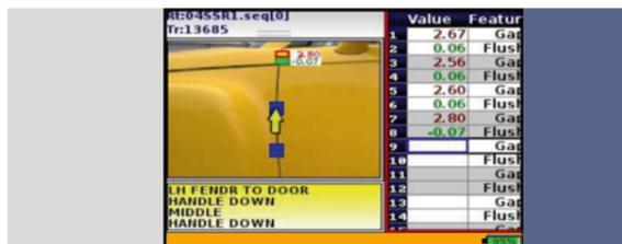
■ **Messmittel-Modus** – Der LG5000 unterstützt alle bekannten LaserGauge® Messmittel-Algorithmen. Erfasste Profile können gespeichert werden und zu einem späteren Zeitpunkt wieder aufgerufen werden, um sie erneut zu bearbeiten. Einstellungen, die im Messmittel-Modus für einen bestimmten Algorithmus gemacht wurden, können auf alle Profile, die man zuvor aufgenommen hat, angewendet werden.
