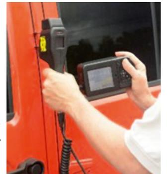
■ **Zusätzliche Punkte** – Wie das High-Kontrast scannen, welches auch für sehr stark reflektierende Oberflächen eingesetzt wird, um ein gut erkennbares Profil aufzunehmen. Der 4-Wege-Rotationsbildschirm, der die Handhabung für Links- bzw. Rechtshänder möglich macht und der schnelle Wechsel des Akkus, der auch während einer Prüfung durchgeführt werden kann.
